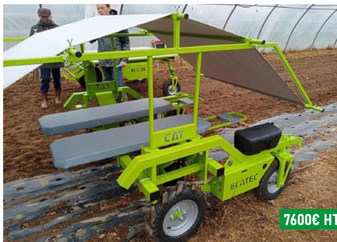
Il s'agit d'un porteur automoteur électrique pouvant accueillir de 1 à 4 couchettes permettant d'assurer des tâches de plantation ou de désherbage dans une position plus confortable et ergonomique. L'opérateur est allongé sur la couchette, des supports permettent de reposer le front et le menton. La hauteur de la couchette est réglable pour s'adapter à la longueur des bras de chacun (il existe 3 niveaux de réglage).
