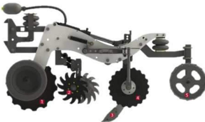
Cette technique permet de préparer mécaniquement le lit de semence et de décompacter le sol sans retourner les horizons, tout en impactant un minimum l'activité biologique du sol dans l'inter-rang et en évitant de provoquer la levée d'adventices par un travail de surface. Par ailleurs, ce travail réduit permet de diminuer largement la consommation de carburant et le temps consacré à la préparation du sol.
